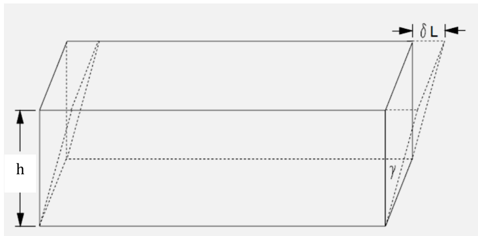
Figura 1.11. Representación esquemática de una deformación bajo cizalla (Steffe, 1996).
