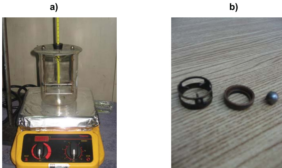
Figura 9. a) Sistema para determinación del punto de ablandamiento b) Soporte, anillo y bola.
