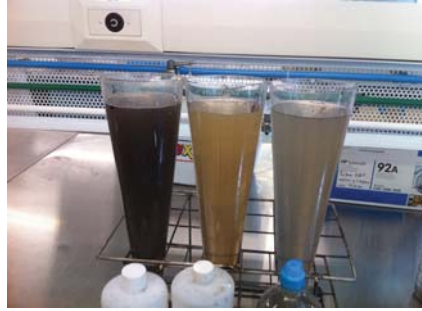
2.- Prueba de Sólidos sedimentables en los 3 pozos para el mes de Septiembre de 2012. Obsérvese el contraste entre cada uno de los conos Imhoff.
