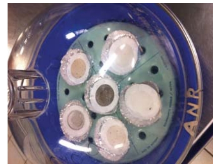
2.- Prueba de Sólidos Suspendidos Totales en los 3 pozos para el mes de Septiembre de 2012. Obsérvese el contraste de color entre cada uno de los filtros que denota la presencia de sólidos.
