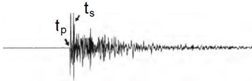
Figura 15. Muestra la diferencia en los arribos de tiempo de las ondas P y S para poder conocer si se encuentra dentro de un sismo local.
