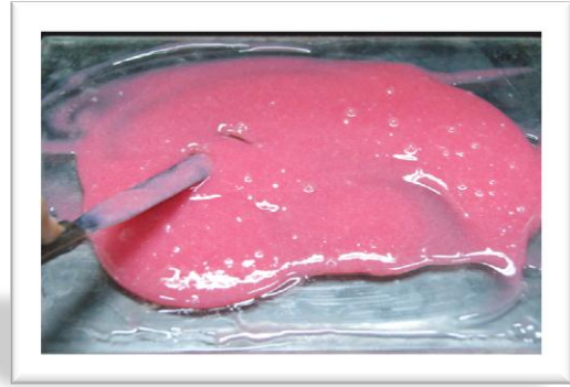
Imagen 2.31, 2.32. Incorporación y mezclado de 0.5 g de Fibras Flock color rojo en los diferentes tipos de silicón.
