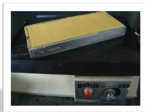
Imagen.2.6. Vibración del yeso en la mufla de acero.
