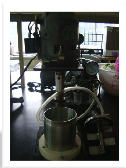
Imagen 2.20. Recipiente de acero inoxidable y mezcladora al vacío.
