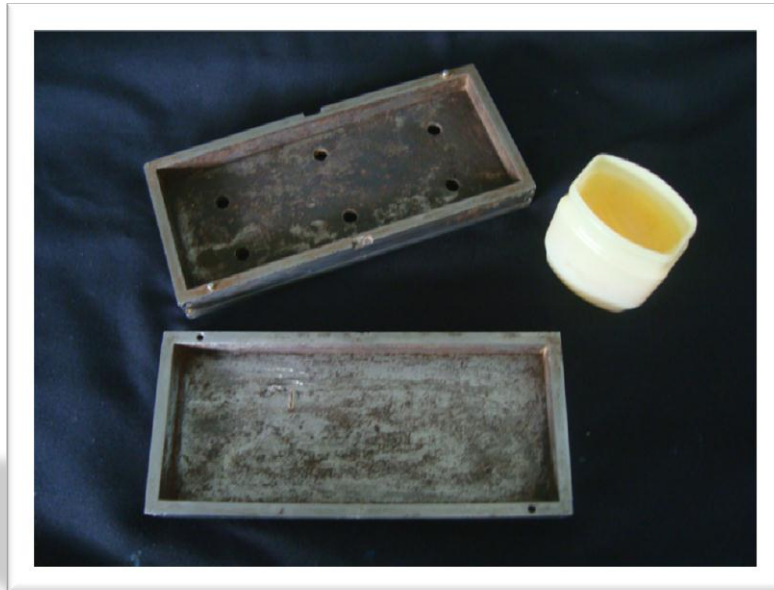
Imagen.2.1. Mufla de acero 1018 (S.A.E.) de 6.35 mm x 15.87 mm.
