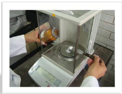
Imagen 2.18, 2.19. Pesado de silicio y silicón en balanzas Contadora y TOR-REY.
