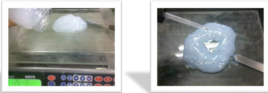
Imagen 2.21, 2.22. Pesaje de silicón Experimental en balanza Contadora y colocación de catalizador en gotas.
