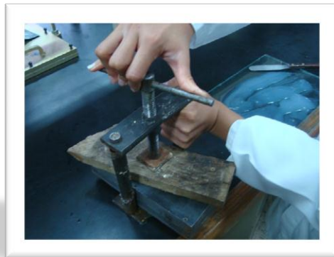
Imagen 2.25. Prensado de la mufla con silicón experimental.
