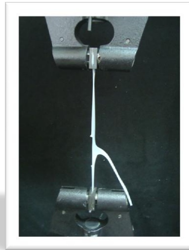
Imagen 2.44, 2.45. Muestras de silicón sin fibras para resistencia al desgarre y prueba de desgarre en Máquina Universal de Pruebas Mecánicas INSTRON 5567.
