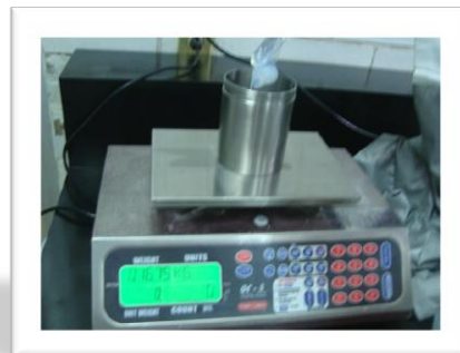
Imagen 2.18, 2.19. Pesado de silicio y silicón en balanzas Contadora y TOR-REY.
