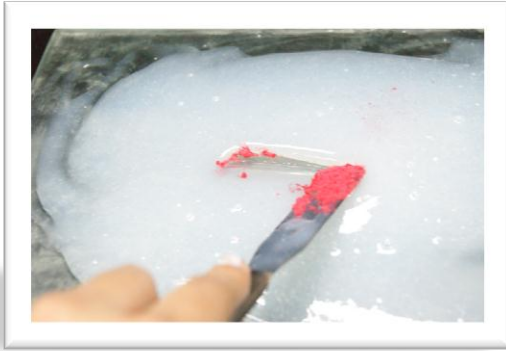
Imagen 2.31, 2.32. Incorporación y mezclado de 0.5 g de Fibras Flock color rojo en los diferentes tipos de silicón.
