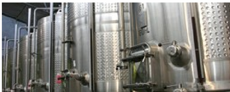
8. Fermentación en tanques de acero inoxidable con chaquetas de enfriamiento.
