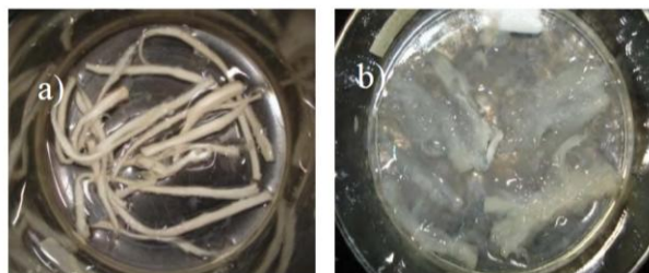
Figura 5. Solubilización de tendón (a) en ácido acético 0.5 M hasta la obtención de un gel traslúcido (b).
