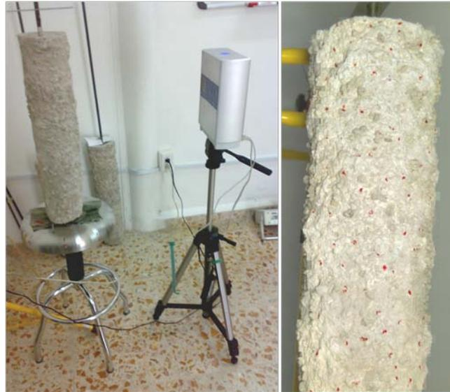
**Figura 4.6 Arreglo para realizar el escaneo tridimensional láser**
