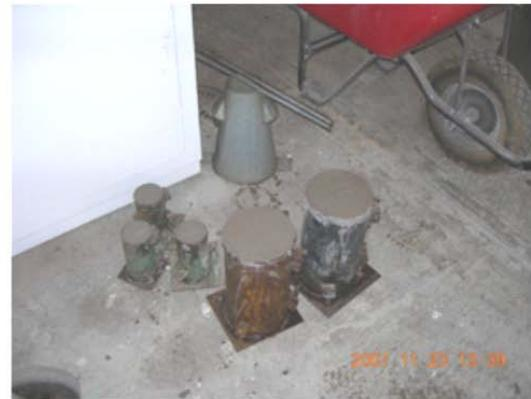
Cilindros para ensayos de resistencia
