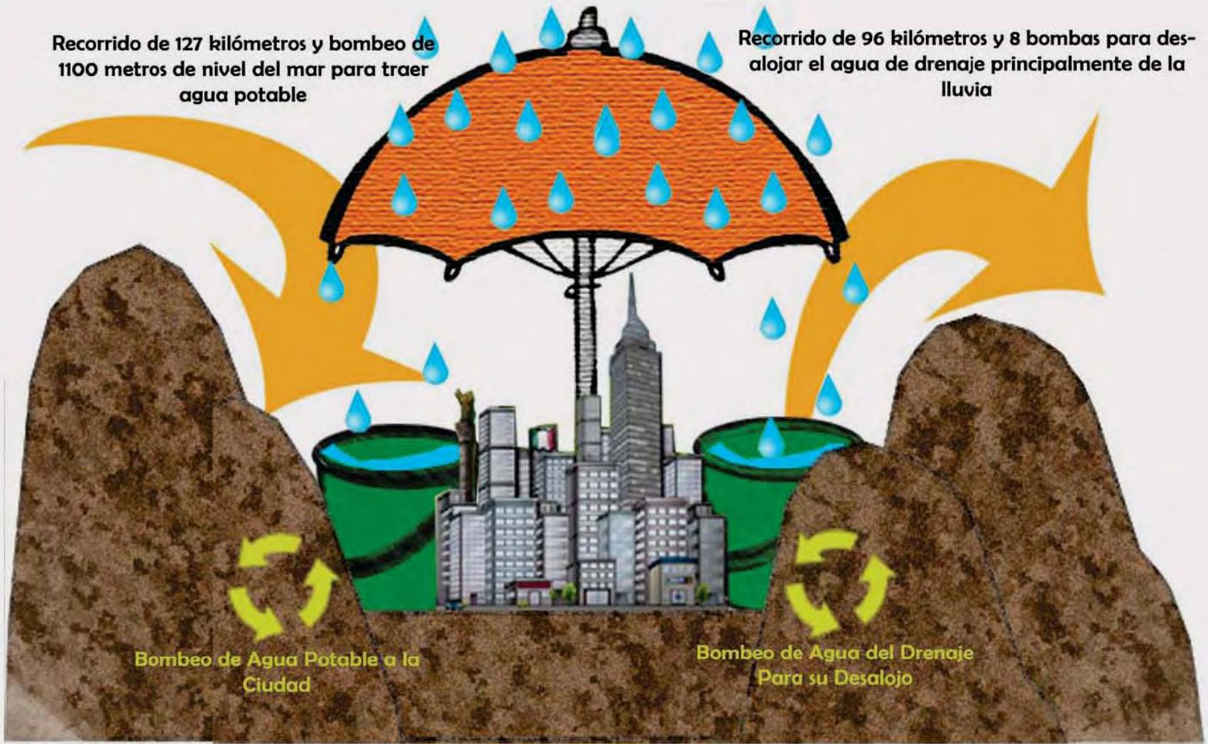
Recorrido de 127 kilómetros y bombeo de 1100 metros de nivel del mar para traer agua potable
