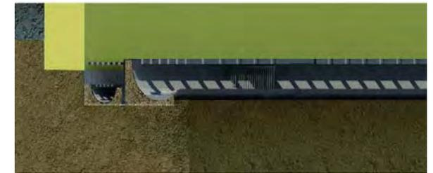
4 La acequia estará formada por dos secciones: la primera a un lado de la guaración de la banqueta y servirá para las aguas grises de las viviendas y se conectará con las atarjeas. A un costado y de mayor tamaño, se encontrará la segunda sección para la recolección de las aguas de lluvia de las calles y la cual llevará lo recolectado hasta la Planta de Sustentabilidad.
