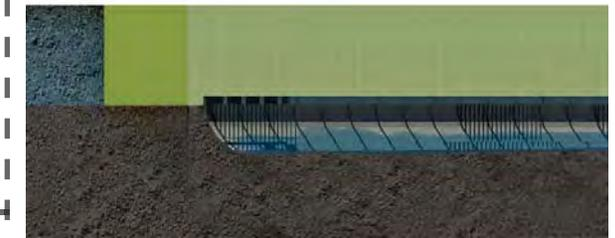
5 La acequia estará construida con secciones de semi-circulares de concreto y rejas de acero que permitirán la filtración del agua.
