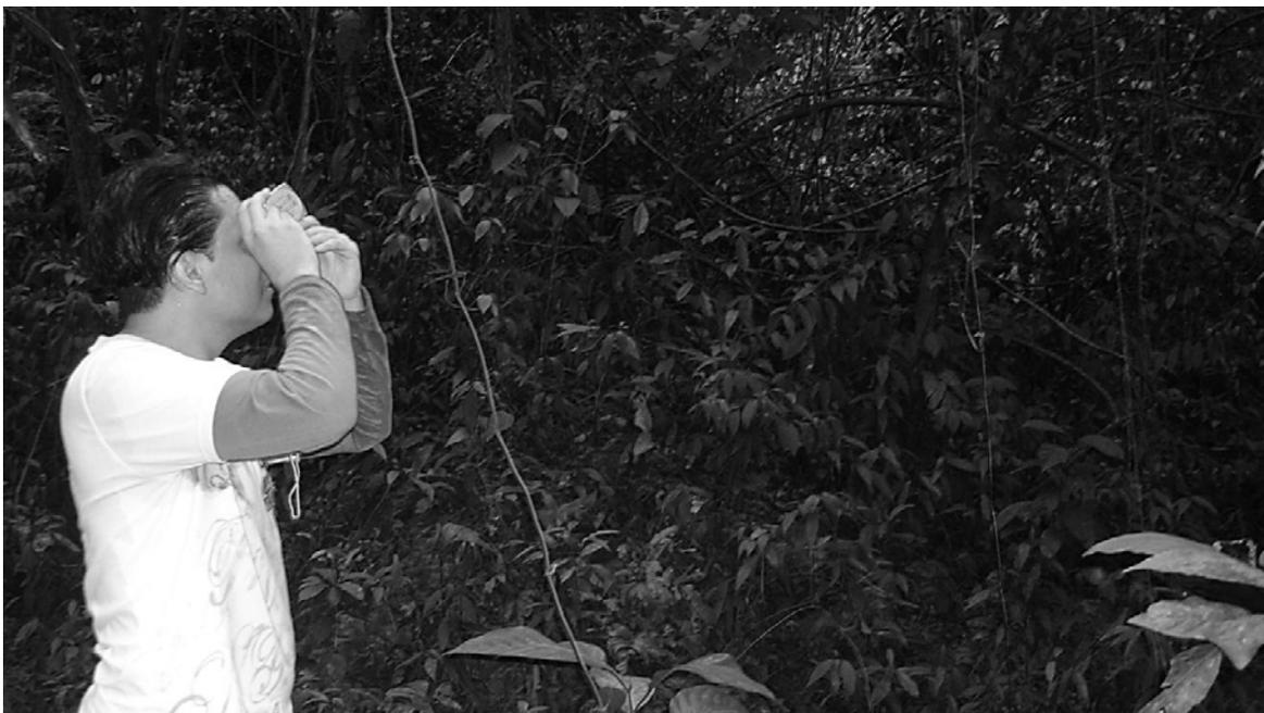
**Figura 137. Cálculo de los ángulos a las cimas y bases de las colinas kársticas residuales**
