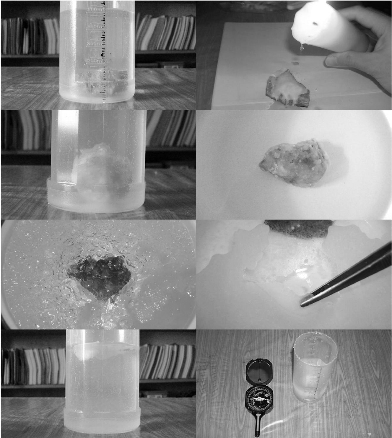
Figura 147. Método gravimétrico de recubrimiento para la determinación de porosidad
