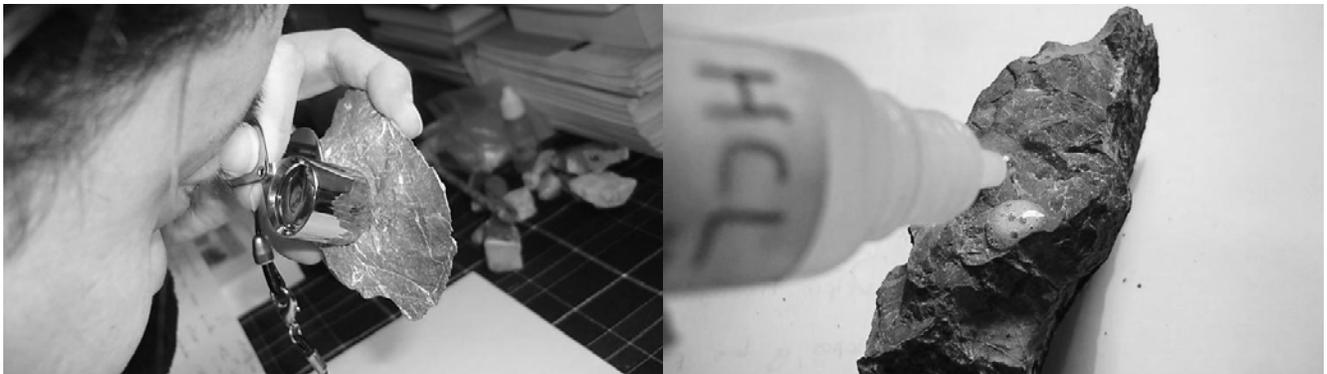
**Figura 141. Observación de minerales superficiales y velocidad de reacción al ácido clorhídrico**
