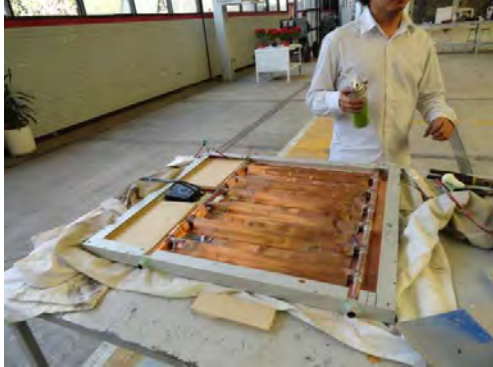
Gráfico A.3.13 Limpieza del sistema para aplicación de espuma poliuretano
