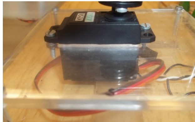
Figura 4.5 Servomotor ensamblado en la base del motor
