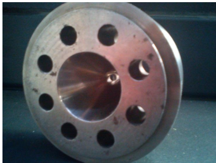
Figura 5.6 Dado de sección circular con diámetro de extrusión de 4.78 [mm]
