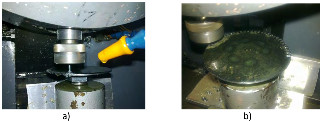
Figura 4.10 Fabricación del disco encoder .
