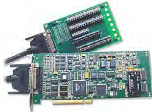
Figura 3.27 Tarjeta de adquisición de datos DT3010 de DATATRANSLATION
