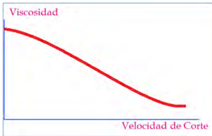
Figura 2.5 Comportamiento común de un material pseudoplástico.
