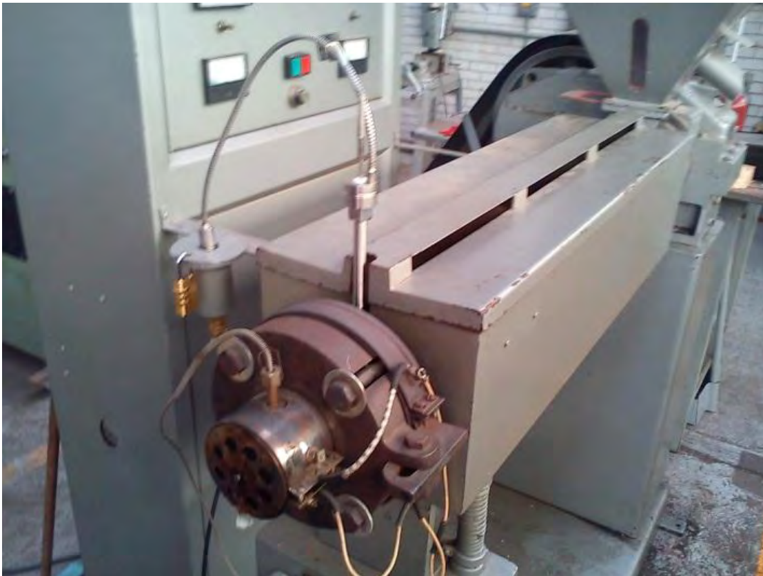
Figura 5.1 Máquina de extrusión instrumentada en el laboratorio de procesamiento de plásticos en la Facultad de Ingeniería de la UNAM
