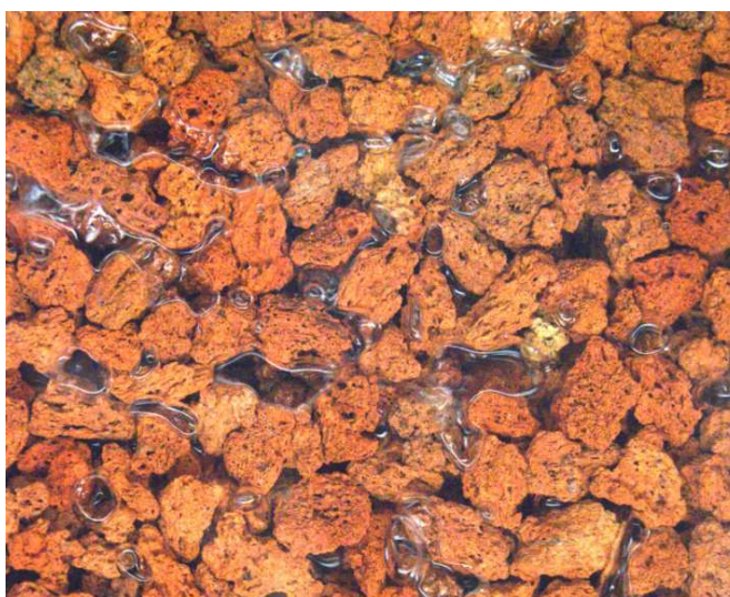
Figura 6.22 Burbujas de aire retenidas entre los espacios vacíos del medio filtrante nuevo, tamaño de partícula 4.7 mm
