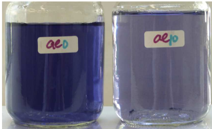
Figura 8.6 Apariencia del influente y efluente para la carga orgánica de 11.9 kgDQO d /m 3 .d
