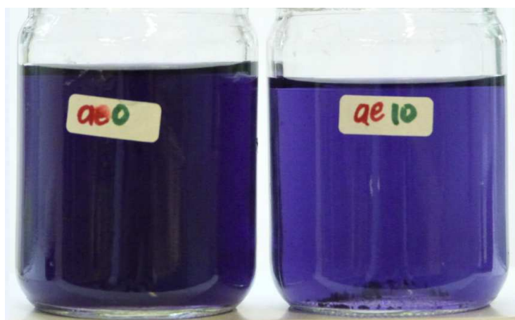
Figura 8.4 Apariencia del influente y efluente para la carga orgánica de 3.4 kgDQO d /m 3 .d
