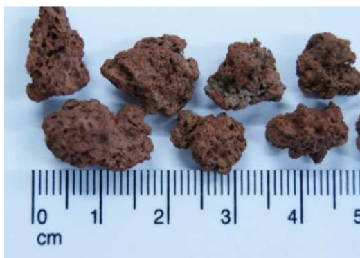
Figura 6.2 Partículas de tezontle con diámetro promedio de 9.5 mm
