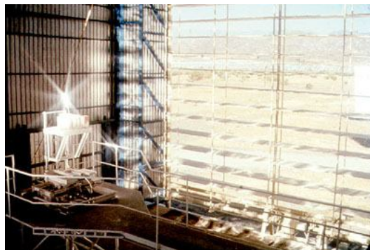
Figura 21 Foco receptor de un horno solar [19].
