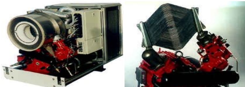
Figura 8 Motor Stirling v160 que se utilizó en la PSA [11].
