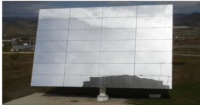
Figura 18 Helióstato con 28 facetas [17].
