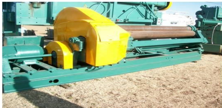
Figura 74 Roladora para placa de acero [39].
