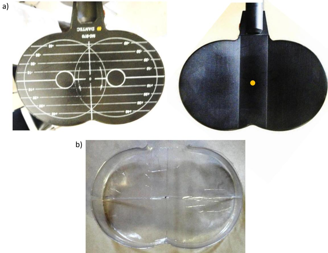
**Figura 10** a) Ubicación del punto de máxima intensidad del campo magnético en el lado opuesto de la bobina; b) Localizador modificado para que embonara con la bobina.
