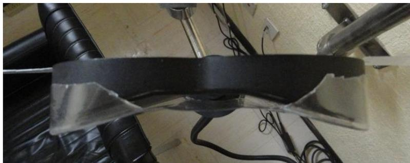
**Figura 9** Molde de PVC de calibre 18 colocado sobre el estimulador (vista lateral).
