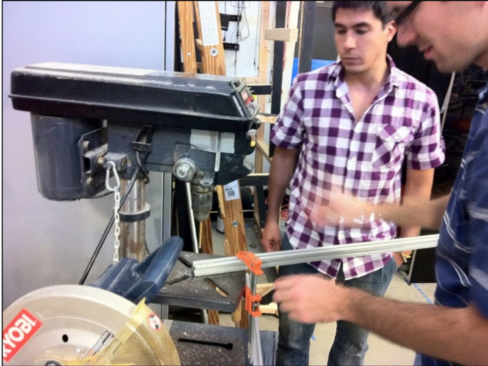
Imagen 35: Barrenando los marcos con ranuras en T.
