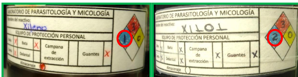
Imagen 5.8 Los grados de riesgo en el rombo de seguridad no son iguales para el mismo reactivo en diferentes frascos
