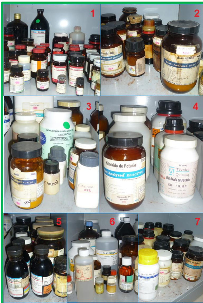
Imagen 5.11 Almacenamiento de reactivos en el Área de apoyo del laboratorio. (1 Colorantes, 2 Ácidos, 3 Carbohidratos, 4 Hidróxidos, 5 Sales de yoduro, 6 Varios, 7 Sales)
