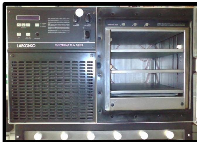
Figura 38. Cámara de liofilización del equipo utilizado, a la izquierda se observa el panel de control de la temperatura, a la derecha la cámara con sus 3 charolas para colocar la muestra.
