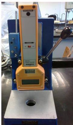
*Figura 13. Dinamómetro Digital Force.*
