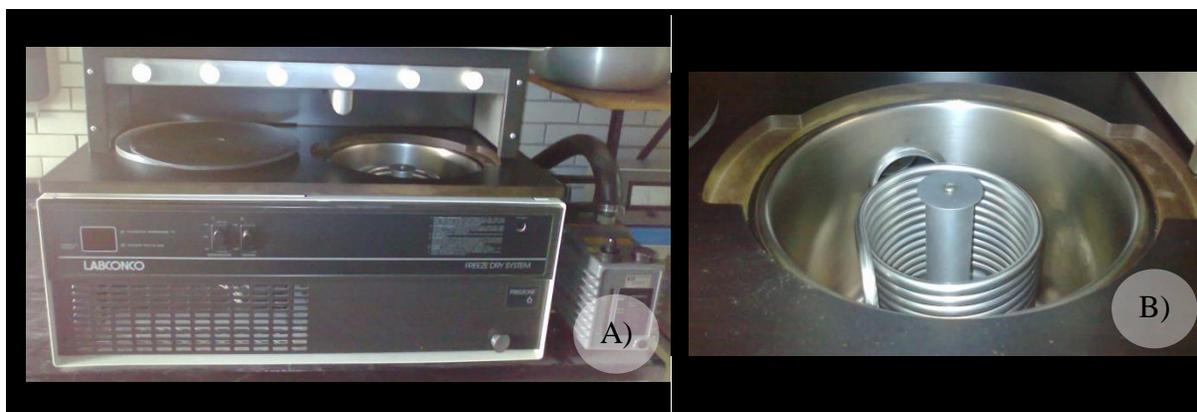
*Figura 39. Condensador del equipo de liofilización. A) condensador con panel. B) serpentín del condensador.*
