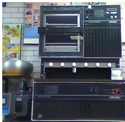
**Figura 11. Liofilizadora utilizada**
