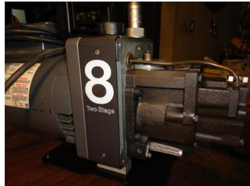
*Figura 40. Bomba de vacío*
