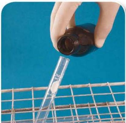
8 En un tubo de ensayo de vidrio, agregar 5 ml de solución amortiguadora.
