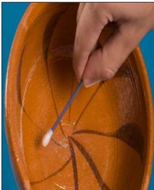
5. Frotar sobre la superficie de la pieza y observar si se presenta un cambio a de color. Si el color va desde un color rosa hasta un rojo indica que hay presencia de plomo (II).
