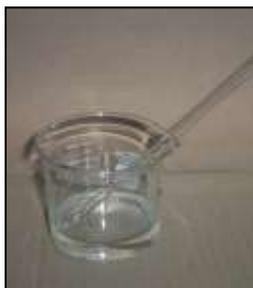
4. Disolver el yoduro de potasio con un agitador de vidrio.
