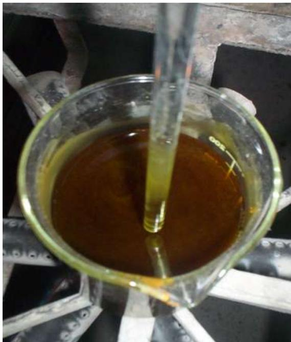
Mezcla solidificada con 200 mL de agua caliente. Indicador Hígado de azufre .Vista por arriba.
