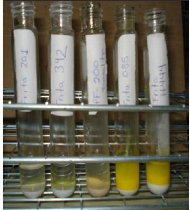
I. Frita 201 sin plomo, II. Frita 392 sin plomo, Esmalte PF-200 sin plomo, Frita 085 con plomo, (color amarilla) V.-Frita H-444 con plomo (coloración amarilla). Fritas y esmaltes con el indicador yoduro de potasio. Una coloración amarilla al contacto indica la presencia de plomo.
