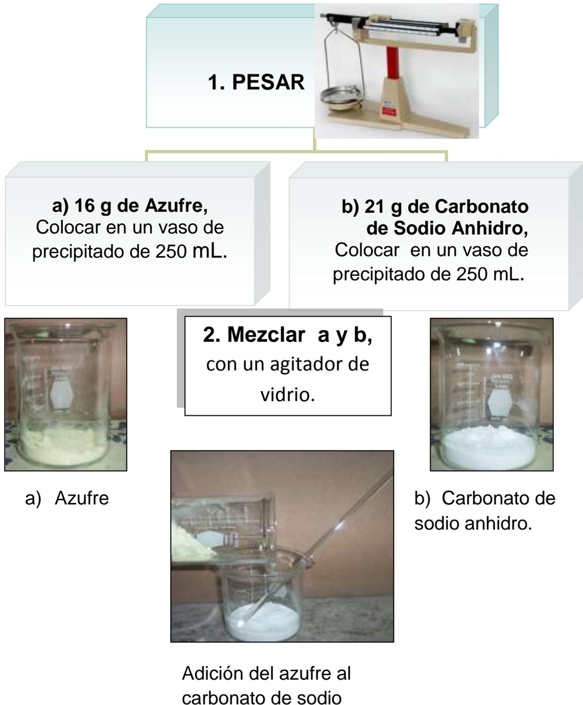
Figura 1. Preparación del sulfuro de sodio, 16 g de Azufre más 21 g de carbonato de sodio anhidro.
