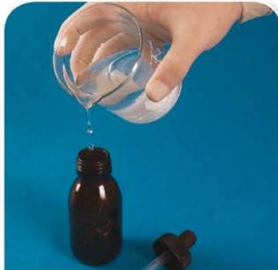
7 Guardar la solución amortiguadora en un frasco de vidrio de 125 ml con gotero.
