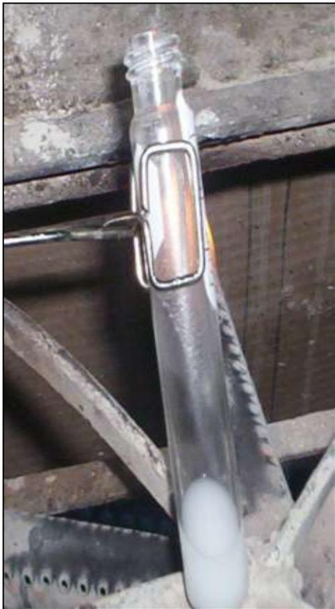
Para evitar salpicaduras en la cara inclinar la boca del tubo hacia el frente.
