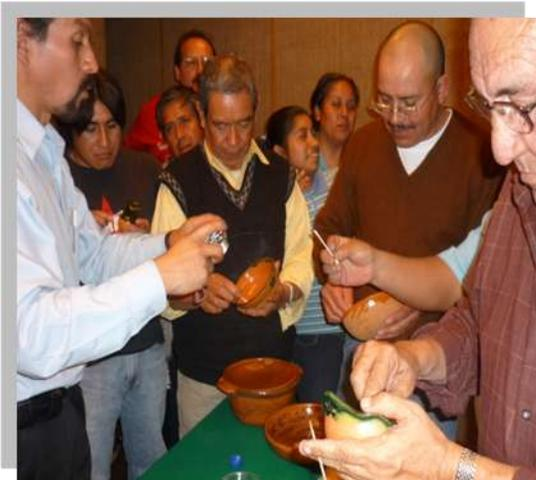
Figura 18. Alfareros aplicando la prueba del rodizonato de sodio para determinar la presencia de plomo en las piezas de barro vidriada. Toluca, Estado de México.
