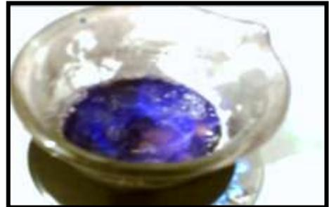
Figura 2. Preparación del sulfuro de sodio, 16 g de Azufre más 21 gramos de carbonato de sodio anhidro calentándose a fuego lento durante 45 minutos aproximadamente. Observaciones: si la mezcla se enciende
