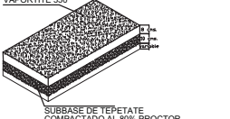
DETALLE DE PAVIMENTO EN PLAZA Y ESCALINATAS
