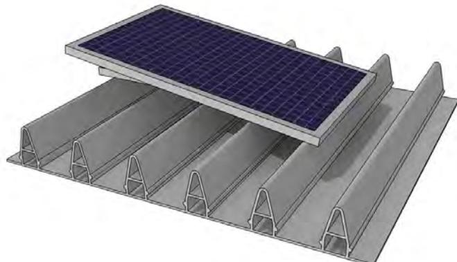
Esquema de montaje de núcleo de celdas fotovoltaicas
