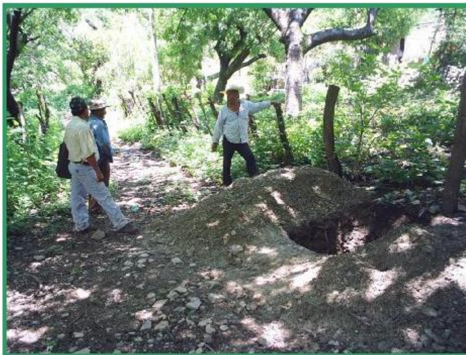
Vereda entre la intersección del camino a Chichicasco El Viejo y el camino al Panteón, en esta zona se realizó un pozo a cielo abierto No.2 encontrándose un material limo arenoso color café claro excavable con pico y pala, en éste tramo se observa la presencia de raíces de árboles.
