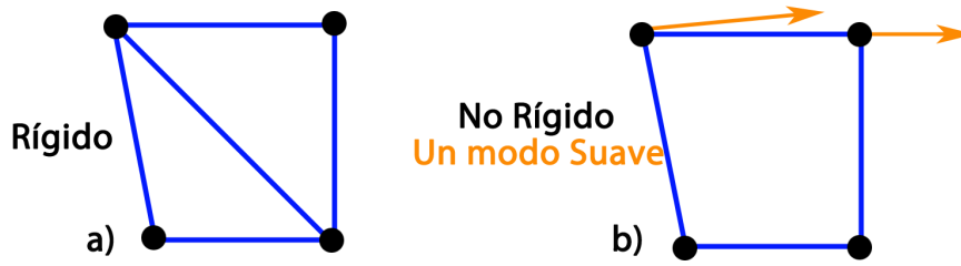
Figura 4.2: Ejemplifica el concepto de modo suave. Se muestran 4 pivotes unidos por barras libres de pivotar. El número de grados de libertad es 8, pero existen 3 modos debidos a la rotación y traslación del centro de masa, esto implica emplear 5 constricciones para hacer rígida a la red. Cuando una restricción es removida, un modo suave aparece como lo indican las flechas. Ejemplo tomado de [43].
