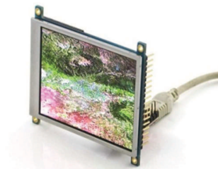
Ilustración 3.8 Imagen en pantalla OLED, fuente www.4dsystems.com.au
