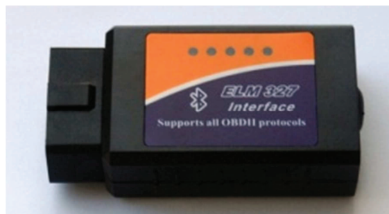
Ilustración 3.2 Escáner ELM327, fuente www.diagnosticoautomotor.com
