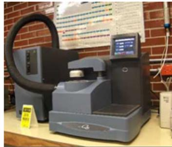
Figura 2.13: Equipo para calorimetría diferencial de barrido modulado (MDSC) Q100.
