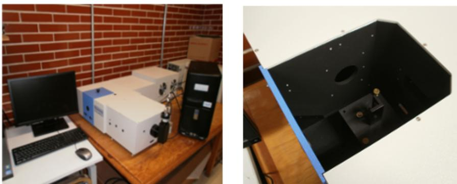
Figura 2.12: Lado izquierdo, fluorímetro. Derecha, apartado de montaje de celda.
