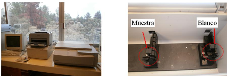
Figura 2.8: UV-vis, espectrómetro, UNICAM.
