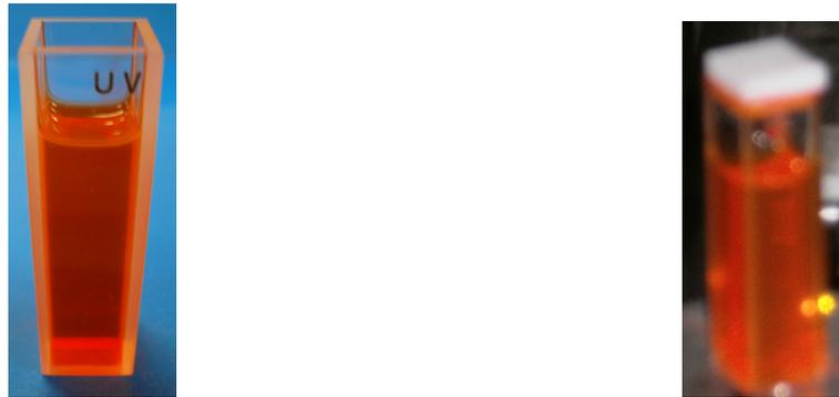
Figura 3.1: Izquierda: sistema MEH-PPV/THF. Derecha: PPV/THF/SiO<sub>2</sub>(100nm, 200nm y 600nm).
