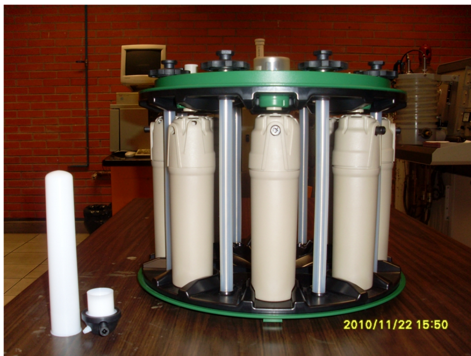
Figura 3.2: Rotor usado para albergar los vasos de síntesis durante la reacción asistida por microondas para la síntesis de nanopolvos del compuesto \text{CuInSe}_2 .
