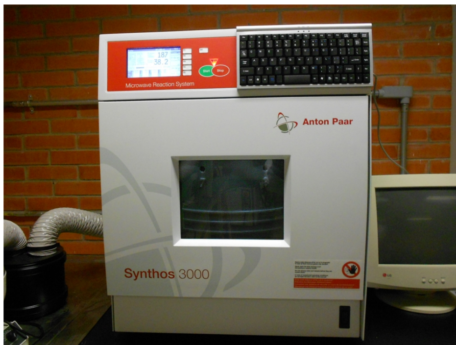
Figura 3.1: Reactor de microondas Anton Paar Synthos 3000; este es un equipo usado para la síntesis química inorgánica, utilizado en la presente tesis para sintetizar nanopulvos del compuesto \text{CuInSe}_2 .
