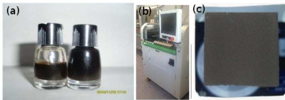
Figura 3.5: (a) Tinta preparada con nanopartículas, (b) impresión de las capas y (c) muestra impresa de nanopartículas.
