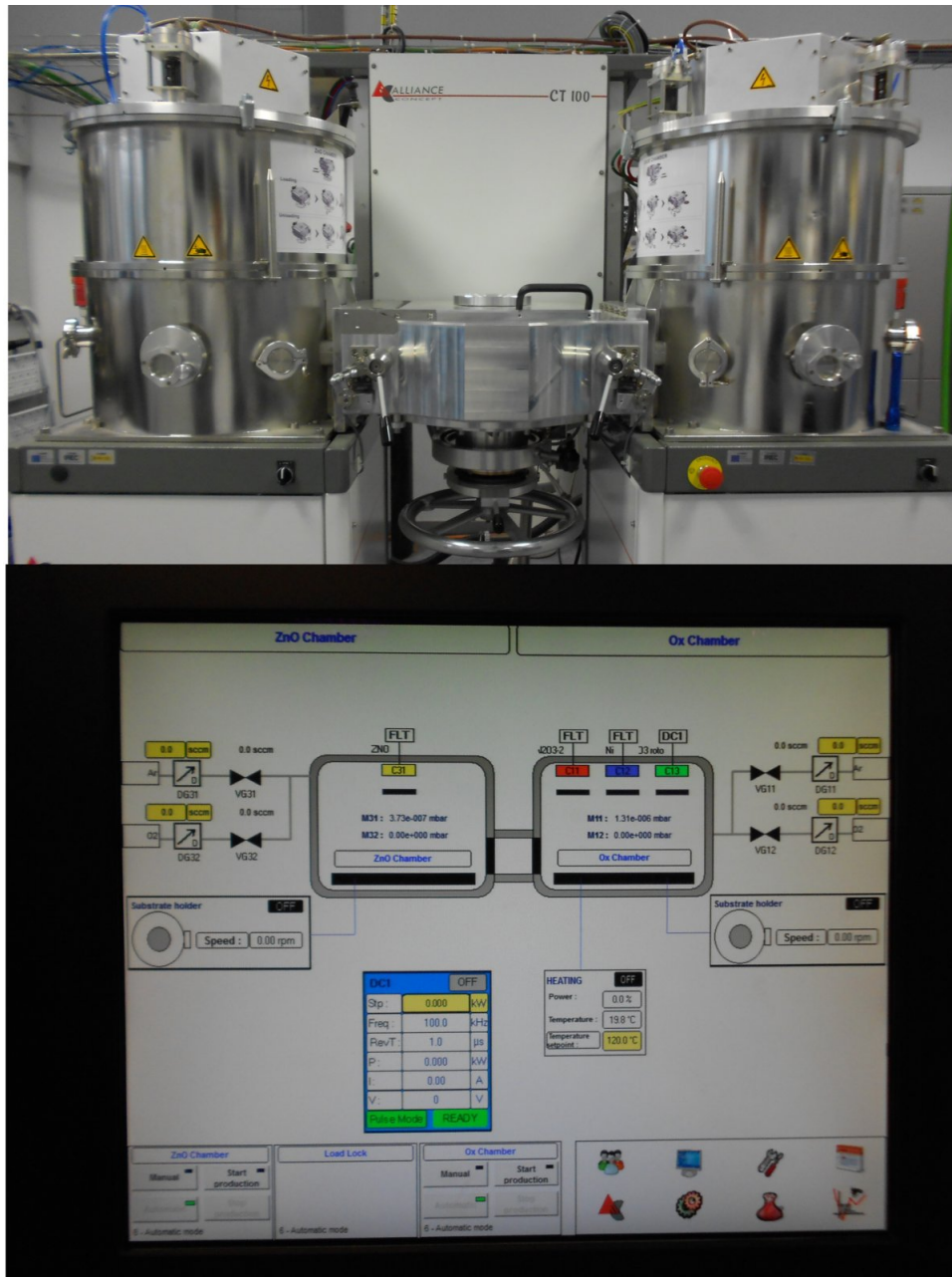
Figura 3.15: Sistema de sputtering para el depósito de óxidos conductores transparentes i\text{-ZnO/ZnO:Al} o i\text{-ZnO/ITO} .
