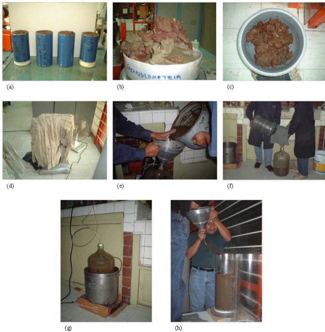
Figura 3.3 Procedimiento de reconstitución de la mezcla de suelo arcilloso: (a) selección del material de los sondeos; (b), remoldeo del material seleccionado; (c), incorporación de agua para obtener un w = 1.5 W_i ; (d), mezclado del material en una batidora industrial convencional; (e, f), vaciado del lodo arcilloso en depósitos de 20 lt para su desaireado; (g) proceso de desaireado del suelo; (h), vaciado del material desaireado en los cilindros acrílicos, con una manguera sumergida para evitar la incorporación de aire en la mezcla
