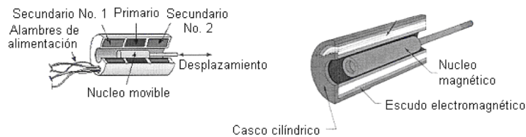
Figura 2.6 Sección de los LVDTs.
