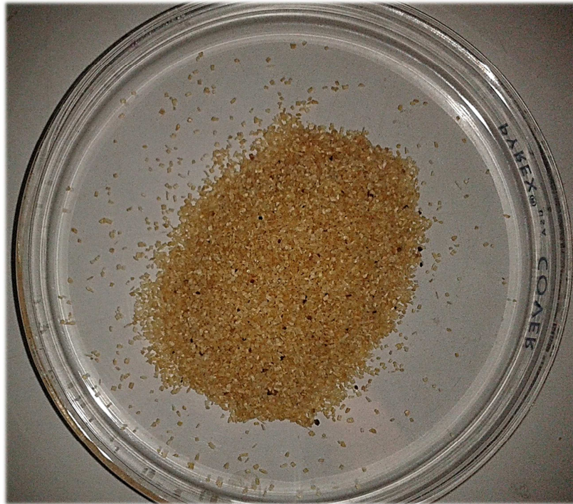
Figura 17. Residuo forestal lignocelulósico utilizado. Madera Ixtlán costera con tamaño de malla 40.
