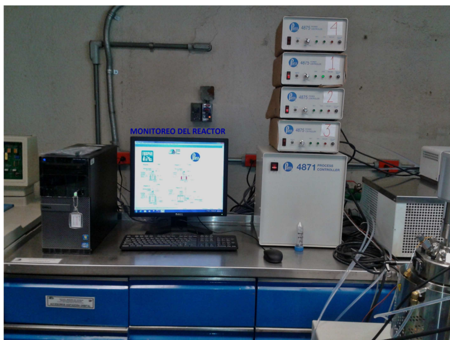
Figura 23. Monitoreo y control del reactor.
