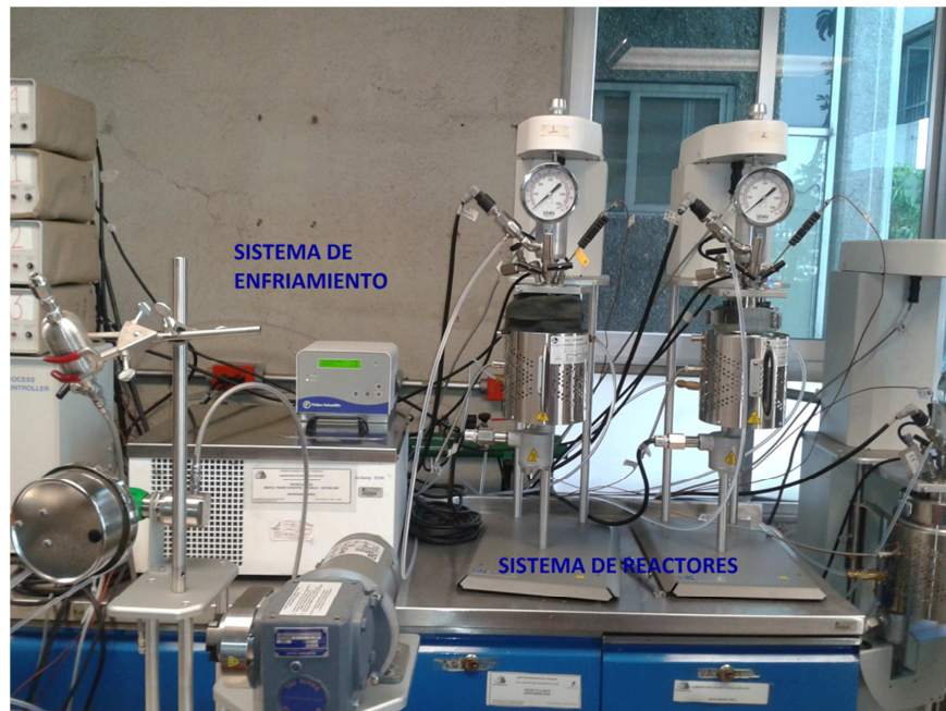
Figura 22. Reactor Parr de alta presión y el sistema de enfriamiento utilizado en la aplicación de pretratamientos.
