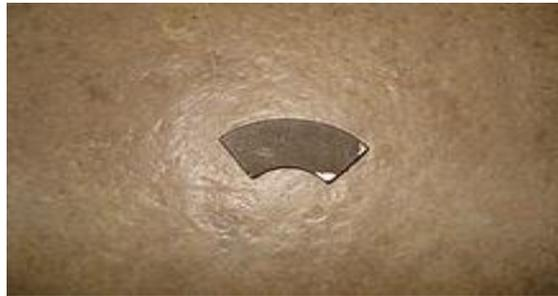
Figura No. 3.2 Imán de neodimio con lámina de níquel parcialmente removida.
