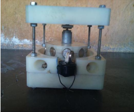
Fotografía No. 7.11 Carcasa y motor de pila.
