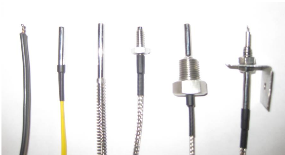
Figura 4.7. Termopares más utilizados.
