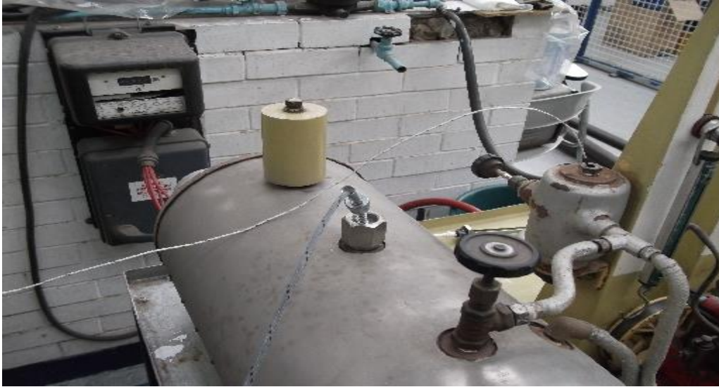
Figura 5.10. Termopares sensando durante la prueba
