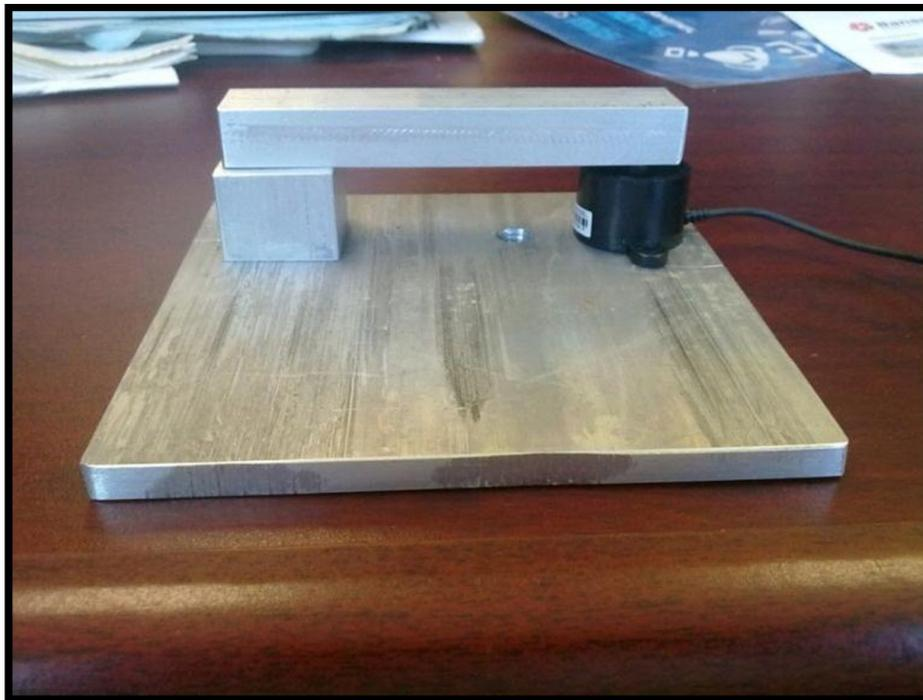
**Fig. 19. Dispositivo para calcular la fuerza de atracción normal de los imanes.**
