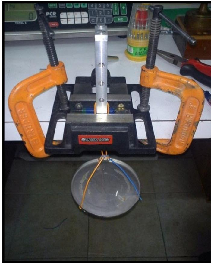
**Fig. 12. Montaje de las pruebas para determinar la fuerza de atracción tangencial de los imanes.**
