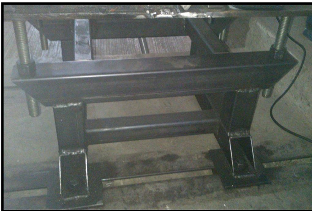
**Fig. 27. Fijación de los tornillos en la base.**
