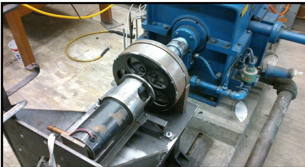
**Fig. 31. Acoplamiento del reductor de velocidad entre los dinamómetros.**
