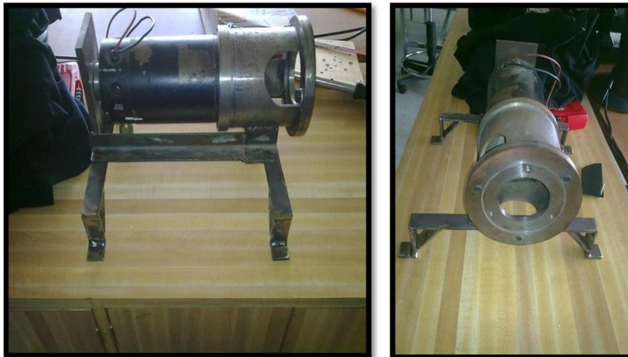
**Fig. 29. Motor-dinamómetro para medir el par de entrada al RVCEM.**
