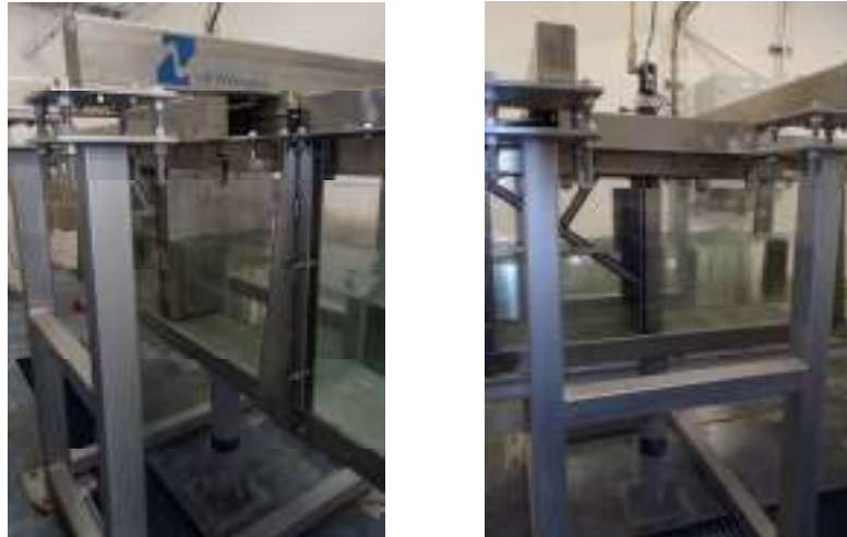
Figura III-2 Pala generadora de oleaje
