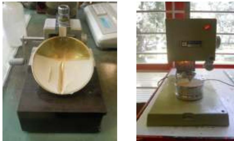
Figura III-16 Equipo utilizado para la obtención del límite líquido Copa de Casagrande para 100C (izquierda) y Cono Sueco para 30A70C (derecha)
