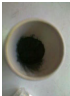
Figura 2.4. Precipitado después del tratamiento térmico a 900^\circ\text{C} .
