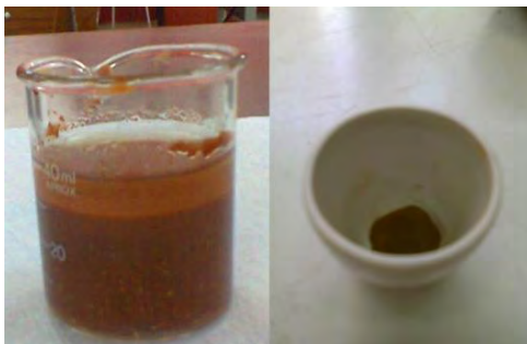
Figura 2.3. Precipitado después de agregar \text{NH}_4\text{OH} (izquierda), precipitado después de el tratamiento térmico a 600^\circ\text{C} (derecha).
