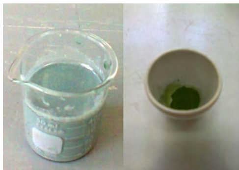
Figura 2.6. Precipitado al agregar \text{NH}_4\text{OH} (izquierda) y precipitado después del tratamiento térmico a 900^\circ\text{C} (derecha).
