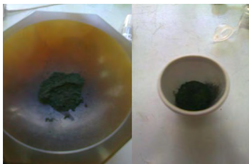
Figura 2.5. Pulverización de reactivos en el mortero (izquierda), y posterior tratamiento térmico a 900°C (derecha).
