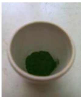
Figura 2.7. Óxidos de Bi (III) y Cr (III) después del tratamiento térmico a 900^\circ\text{C} .
