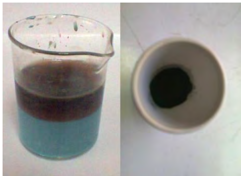
Figura 2.8. Precipitado al agregar \text{NH}_4\text{OH} (izquierda) y precipitado posterior al tratamiento térmico a 600°C (derecha).
