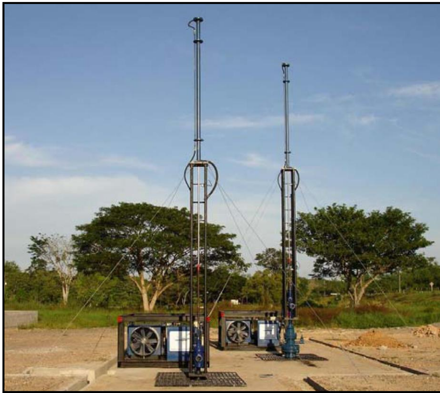
Figura 5.14 Fotografía de un par de unidades hidráulicas de bombeo mecánico Tieben (SERINPET, 2007).
