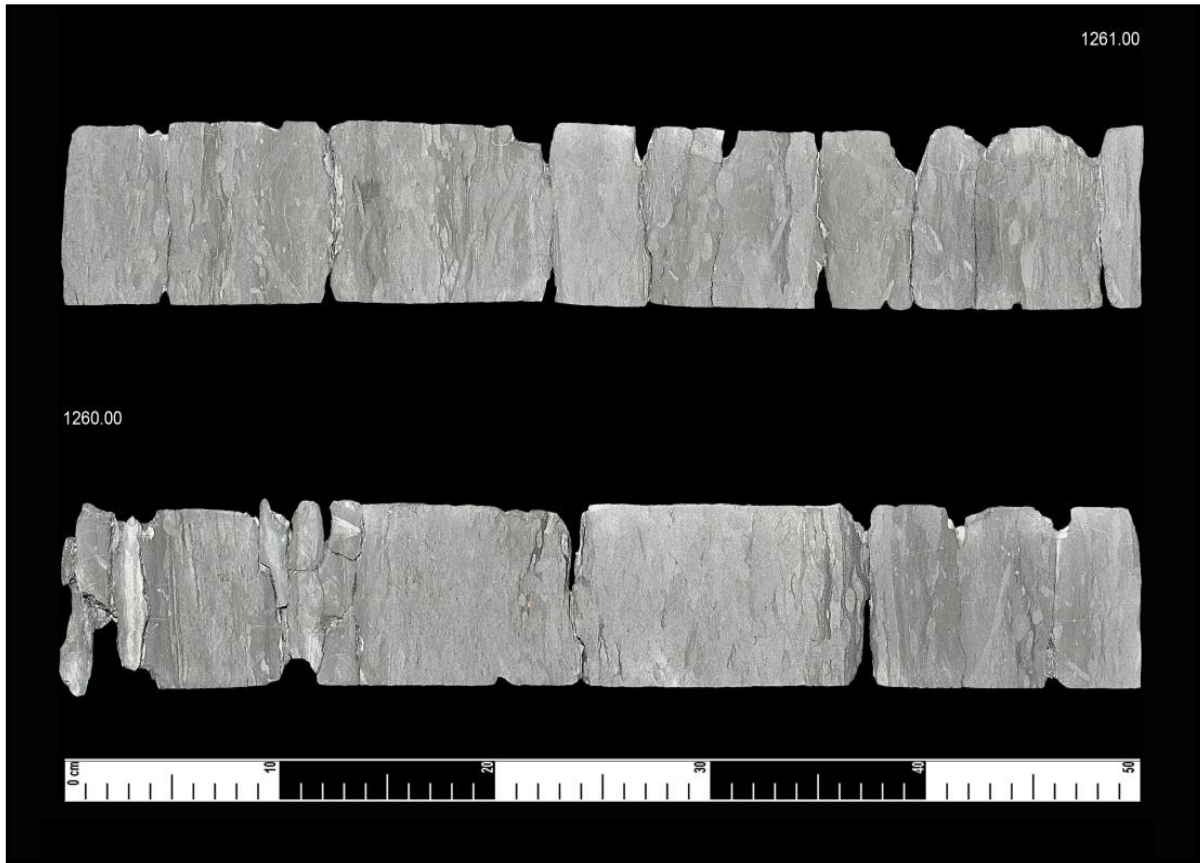
Fig. 5.4 Intervalo del núcleo de 1260 – 1261 metros con ligera impregnación de aceite del Pozo Madrina 1017, del Campo Palo Blanco (CNH-UNAM, 2012) 23 .
