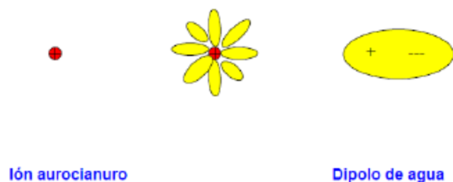
Fig. VII.I. Moléculas de agua ligadas al ión aurocianuro (rojo) que ingresan entre las hojas de la estructura de la arcilla, que van a ser extraídos por los iones sodio o de calcio que están entre dichas laminas y por los iones \text{OH}^- situados en los bordes [43].
