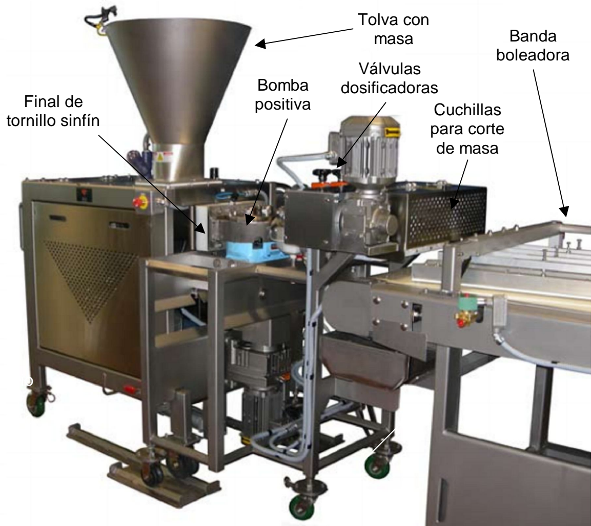
Figura 1.4 Divisora de alta velocidad para bollería.
