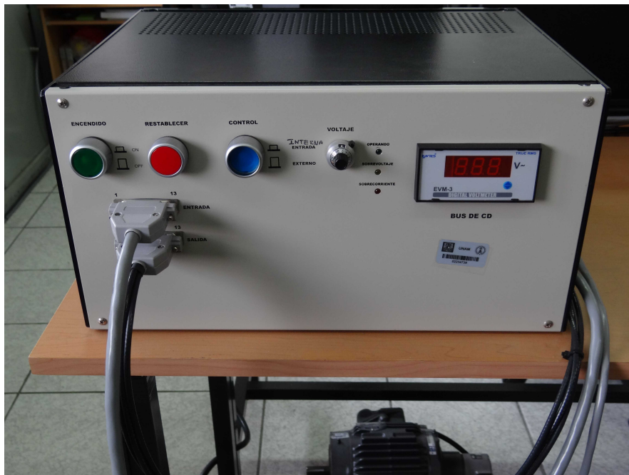
Figura A.7. Rectificar-inversor trifásico de 3kW
