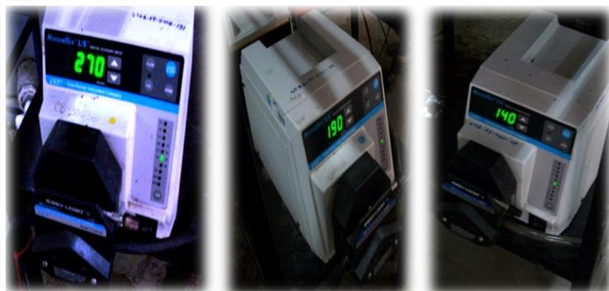
Foto 3.3 Bombas utilizadas para la recirculación en el R1, R2 y R3.
