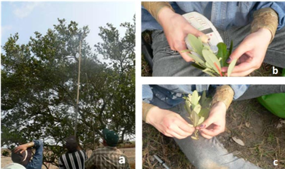
*Figura 6.2 Proceso de colecta y marcado de las hojas de mangle. a) Colecta con tijeras telescópicas. b) Determinación de ICC con el equipo portátil Opti-Sciences CCM-200. c) Marcado de hojas con cinta de plástico.*
