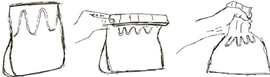
Figura 4.1 Empaque con alambre con memoria de forma
