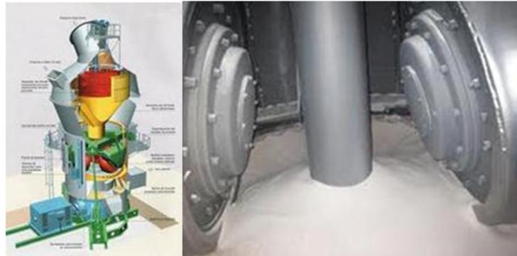
**Figura 11. Molino vertical de crudo.**
