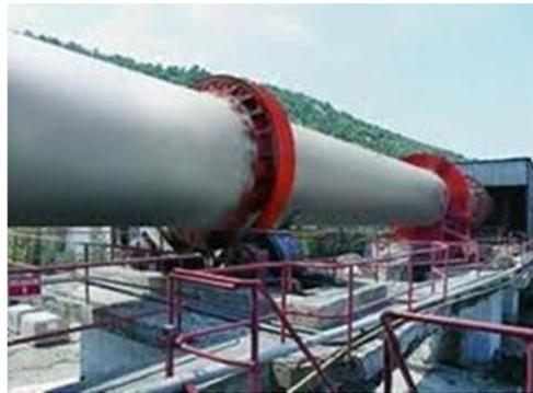
Figura 13. Horno rotatorio de cemento.
