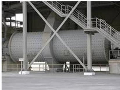
**Figura 15. Molino de bolas para clinker.**
