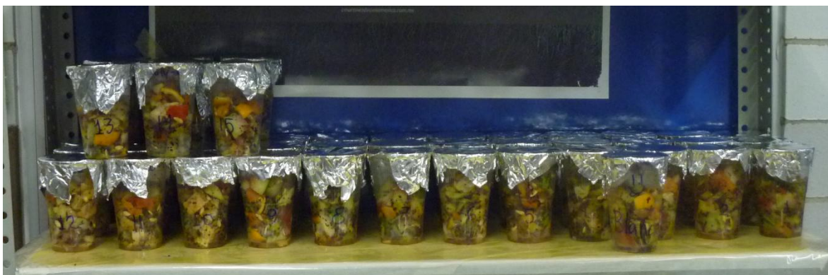
Figura 1. Pruebas de biodegradación de los biopolímeros sintetizados. Cada película se encuentra inmersa en los recipientes con la composta.
