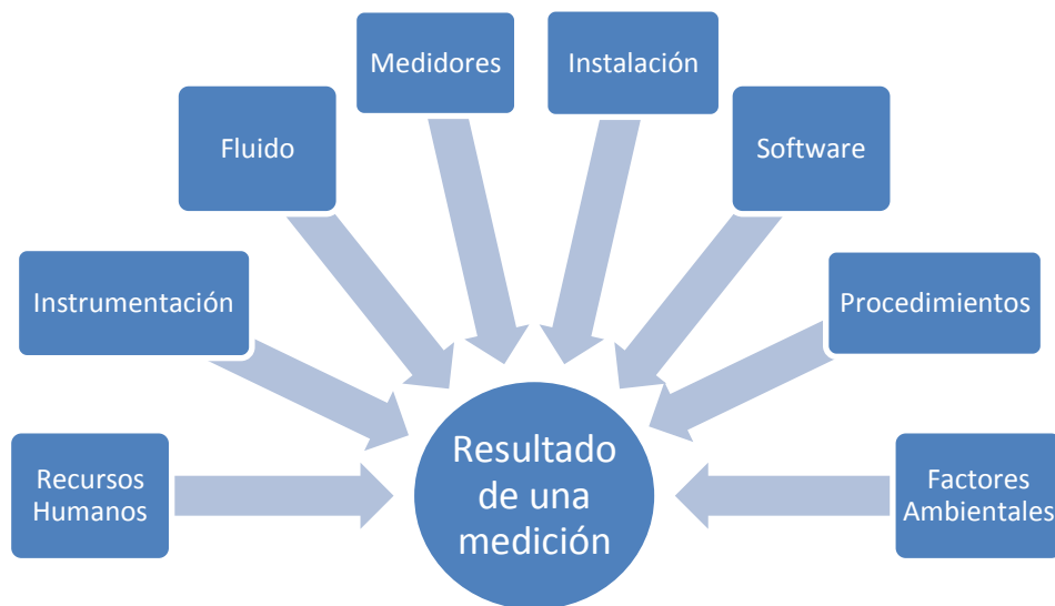
Fig. 2.2 Conjunto de elementos físicos y normativos responsables del resultado de una buena medición conforme lo plantea la gestión y gerencia de medición.
