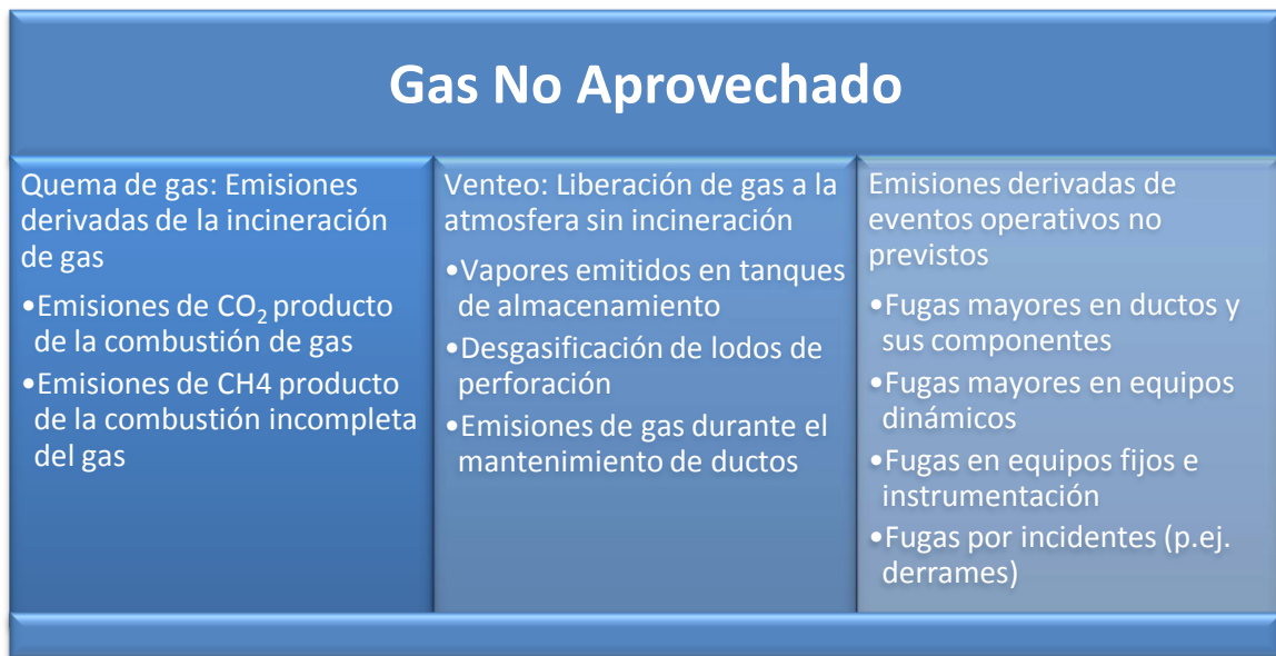
Fig. 5.2 Procedencia del gas no aprovechado en la industria petrolera
