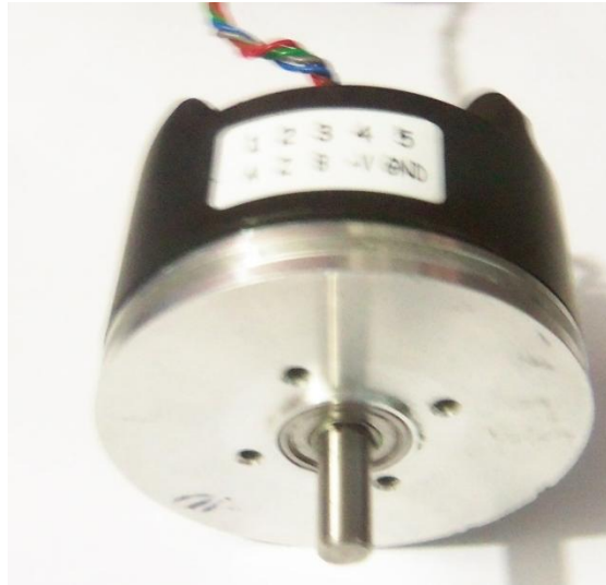
Figura IV-17.- Fotografía del encoder óptico utilizado.
