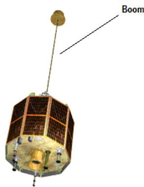
Figura 1.3 Satélite estabilizado por gradiente gravitacional.
