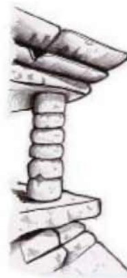
Fig. 5.- Vista parcial de una Columna del edificio anexo a la plaza de la Pirámide de los Nichos en Tajin, Veracruz. Columna aparejada.
