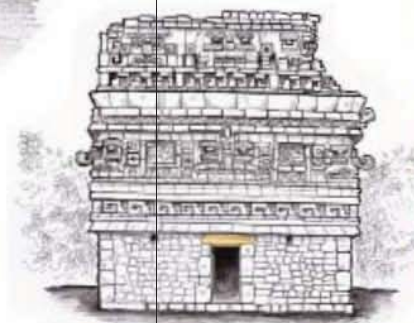
Fig. 3.- Imagen parcial una de las fachadas del Edificio del Conunto de las Monjas en Chichenitzá. Podemos observar como el Dintel cierra o concluye el vano de la puerta en su parte superior.
