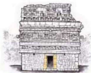
Fig. 6.- Imagen parcial de una de las fachadas del Edificio del Conjunto de las Monjas en Chichenitzá. Podemos observar como las jambas de mampostería soportan el dintel.
