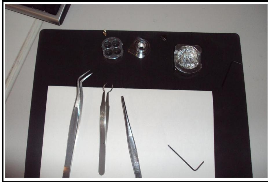
**Figura 2.4 Instrumental para manipular la muestra**
