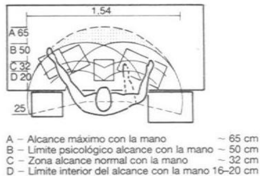
FIGURA 112 Medidas directrices para las zonas de alcance óptimo en un puesto de trabajo.
