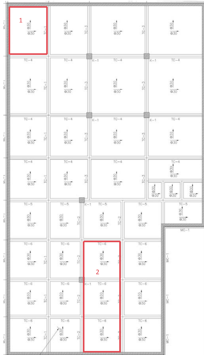
Figura 3.7: Cisterna drenaje estacionamiento (1) y Cisterna para el reaprovechamiento de agua pluvial (2)
